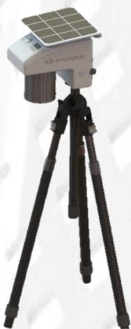
**Connecté au piège passif PA<sub>3</sub>, cet équipement, facilement déployable sur le terrain, est la solution idéale, simple d'utilisation et autonome pour l'analyse et le suivi continu des rejets tritium.**
